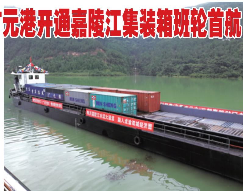
嘉陵江连接川、陕、甘、渝三省市，全长1345公里，是长江水系上游最大支流，也是我国最早实施梯级渠化开发建设的航道，全年可通行500吨级船舶，丰水期可通行1000吨级船舶。去年全江通航，民生集团即跟进行散货运输。今年开行集装箱班轮航线，通过散、集并行的差异化运输，更好满足嘉陵江流域及西北地区的货物水运需求，有力支撑长
